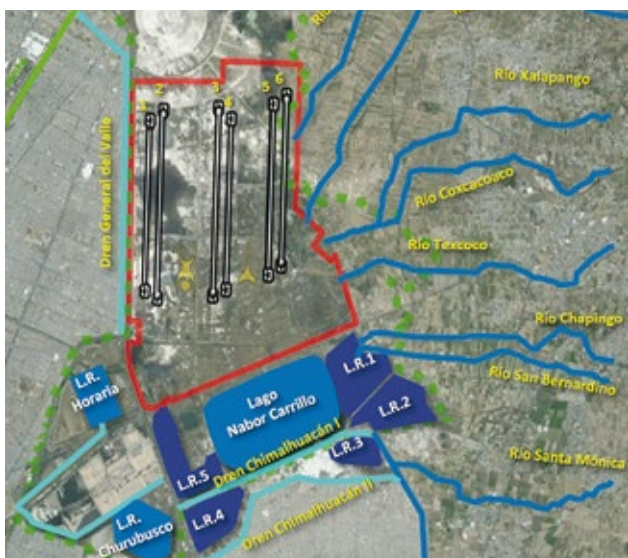
FIGURA 6.6. Rehabilitación de cauces. Rectificar cauces para eficientar el escurrimiento del drenaje natural
